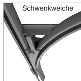
Die fast geschlossene Form der HELM Laufschiene schützt die Lauffläche und die kugelgelagerten Laufrollen vor Schmutz und Farbnebelstaub. Schrägstehende Kanten des Profils garantieren einen spursicheren Lauf der Laufrollen in der Schiene. Ein Absturz der Fahrwerke ist ausgeschlossen. Die Belastung erstreckt sich von 100 - 1000 kg/m Laufschiene. Planung und Ausführung durch Straumann AG.
