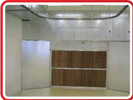
Spritzraum mit Hängebahn
