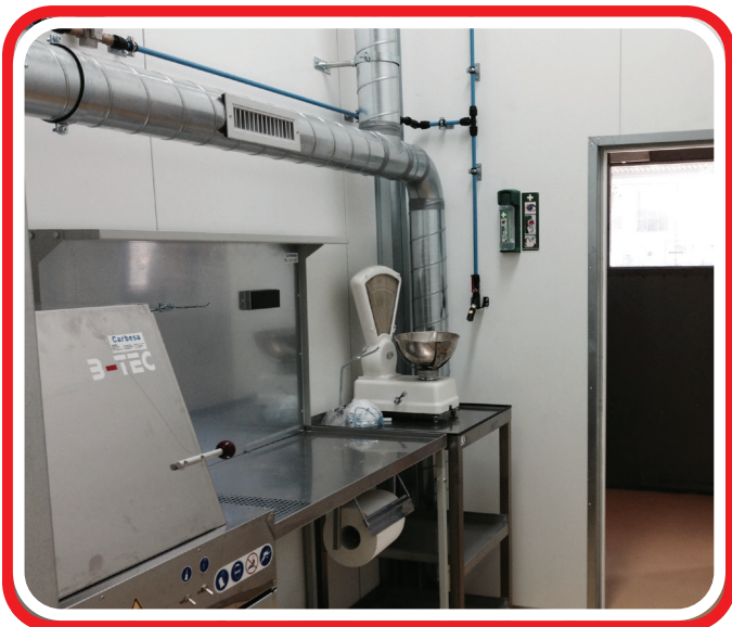
AT01 Rüst- & Misch Tisch 1.18 x 0.61 x 1.42 m Arbeitsfläche in Edelstahl, mit Ablaufwanne 4 Pistolenhalter, 1 Papierrollenhalter, Mg Leiste
