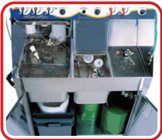
links für Wasserlacke / rechts für Lösemittellacke
