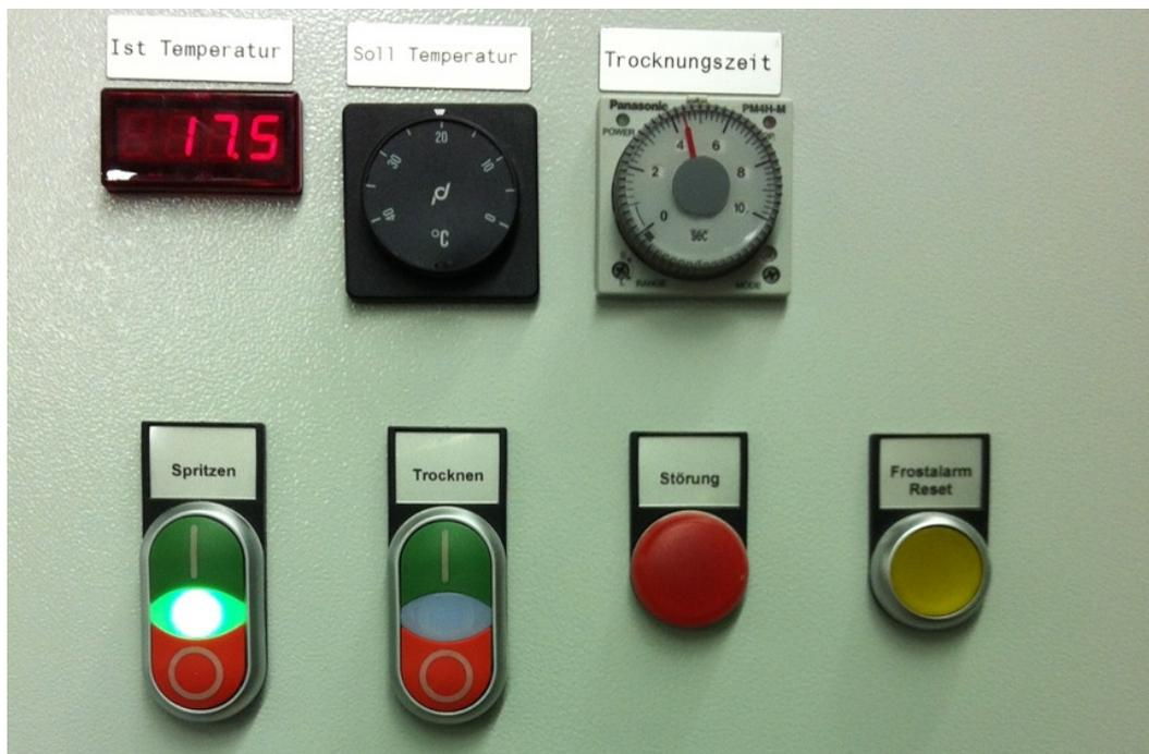
einfache Bedienung, mit Starttaster Spritz- oder Trockenbetrieb, Betriebs- Störleuchten, mit Temperaturanzeige, Temperaturregler und Timer für Trockenbetrieb
